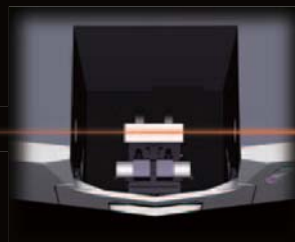
Пламенный анализ: горелка находится на оптической оси (красная линия)
