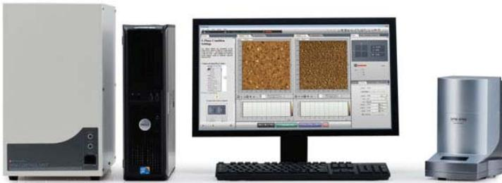
Сканирующая зондовая микроскопия (СЗМ) — один из мощных современных методов исследования формы и локальных свойств поверхности твердого тела.
